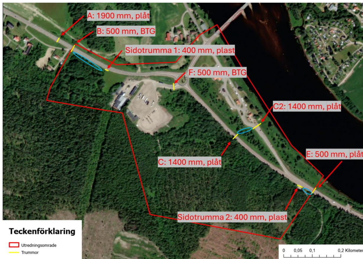
Figur 8. Vägtrummor under riksväg 83. Blåa cirklar redovisar inmätt dikesbotten.
