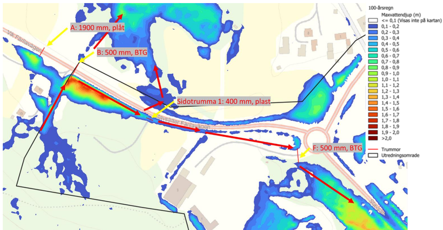
Figur 25. Översvämningssområde C som bildas uppströms om trumma B. Maxvattendjup vid ett framtida 100-årsregn (inklusive klimatfaktor på 1,25). Rinnvägar är redovisade som röda pilar.
